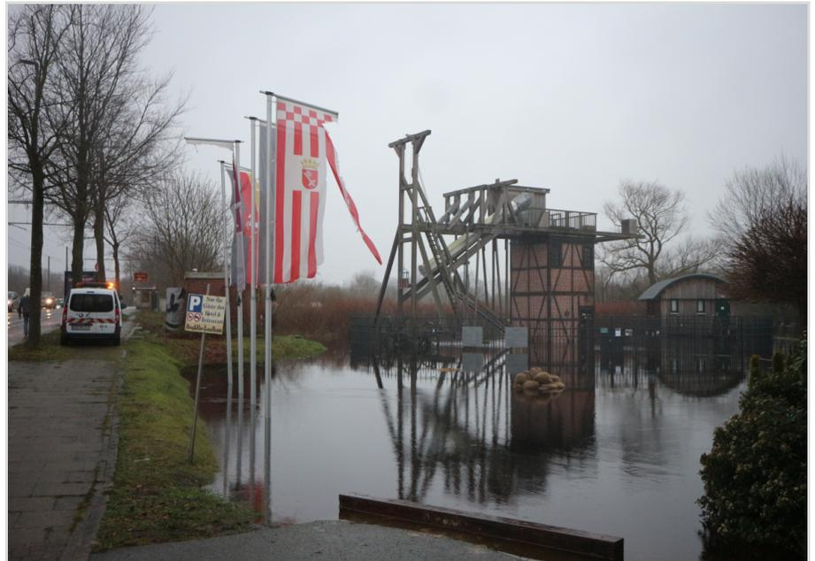
**Abb. 3:** Der höchste Wasserstand am 27.12.2023. Die kleine Insel besteht aus Sandsäcken, die verhindern, dass der Deckel des überfüllten Abwasserkanales hochgedrückt wird. Der Balken schützt Parkplatz-Suchende.
