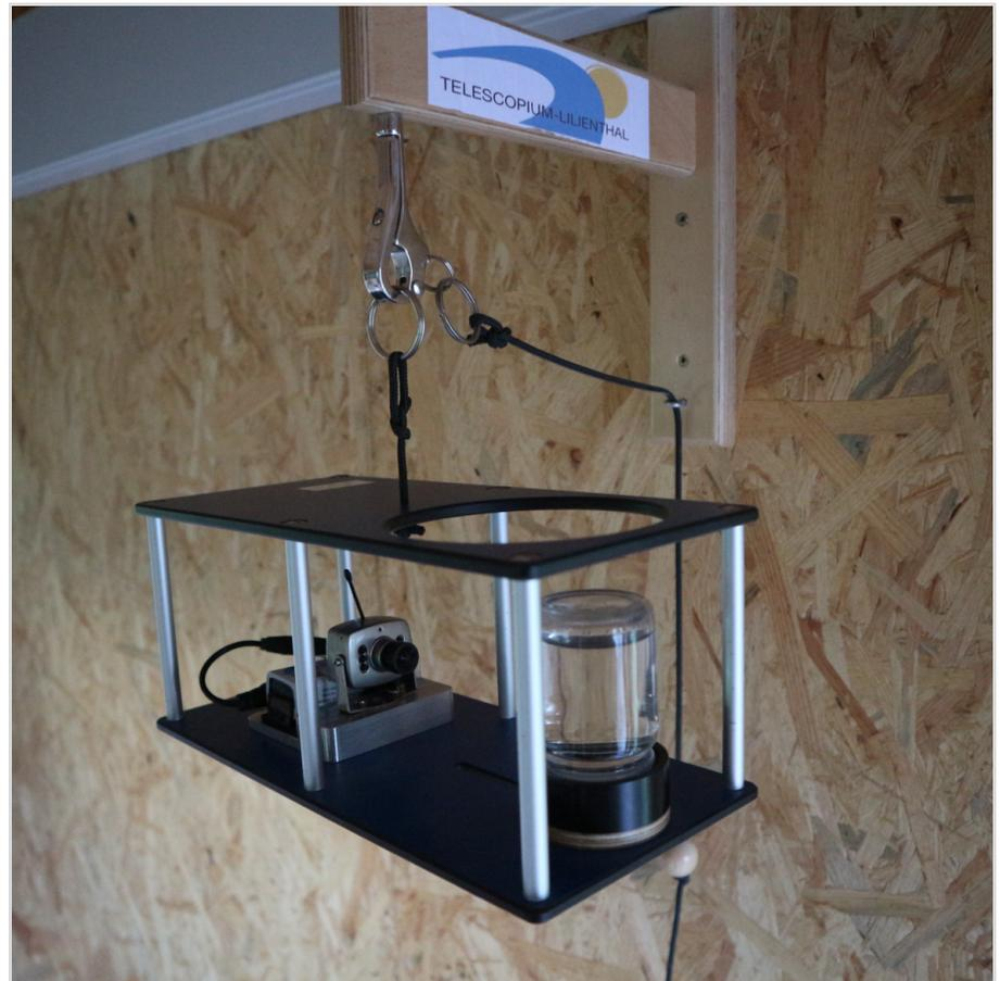
**Abb. 2:** Holzgestell mit „Abwurfvorrichtung“, an deren Haken ein Experimentträger in 2 m Höhe und Raumluftumgebung angehängt ist. Links Mini-Funk-Kamera, rechts Experiment: Flasche mit Wasser und Luft. Gesamtmasse 0,956 kg (Abb. 7). Das Zugseil mit Kugel betätigt den Auslösemechanismus.
