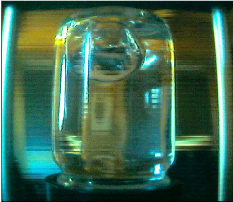
**Abb. 7:** Einzelfoto aus dem 1,5- Sekunden Kurzvideo des Experimentes im freien Fall. Durch die verringerte Schwerkraft gehen Oberflächenspannung und Benetzungskraft der Flüssigkeit verloren und die Luft darüber dringt als kugelförmige Blase in das Wasser.
