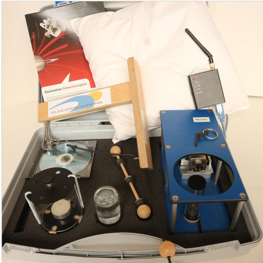
**Abb. 3:** Inhalt des Experimentkoffers: Infobroschüre und Kissen. Darauf liegen die „Abwurfvorrichtung“ (Abb. 2) und ein Funk-Empfänger (schwarz) mit USB-Kabel zum Computer. Links eine CD-ROM mit Software für die Mini-Funk-Kamera, die mit einem Experiment im blauen Experimentträger sitzt. Im Vordergrund 3 weitere Experimente.
