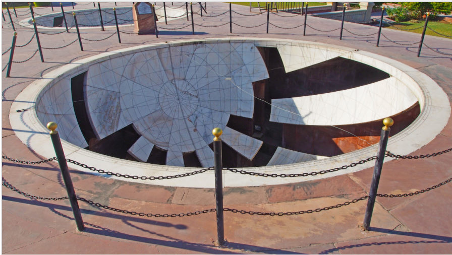
Abb. 8: Jai Prakash Yantra zu Jaipur. Zu erkennen die Darstellung der Himmelskoordinaten. Schwer zu erkennen auf diesem Bild ist der gespannte Metalldraht (vom Pfeiler recht im Vordergrund in Richtung des Himmelspols gespannt).
