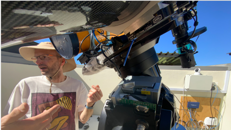
Abb. 9: Suche nach dem Fehler in der Montierung bei aufgeschraubter Hauptachse.
