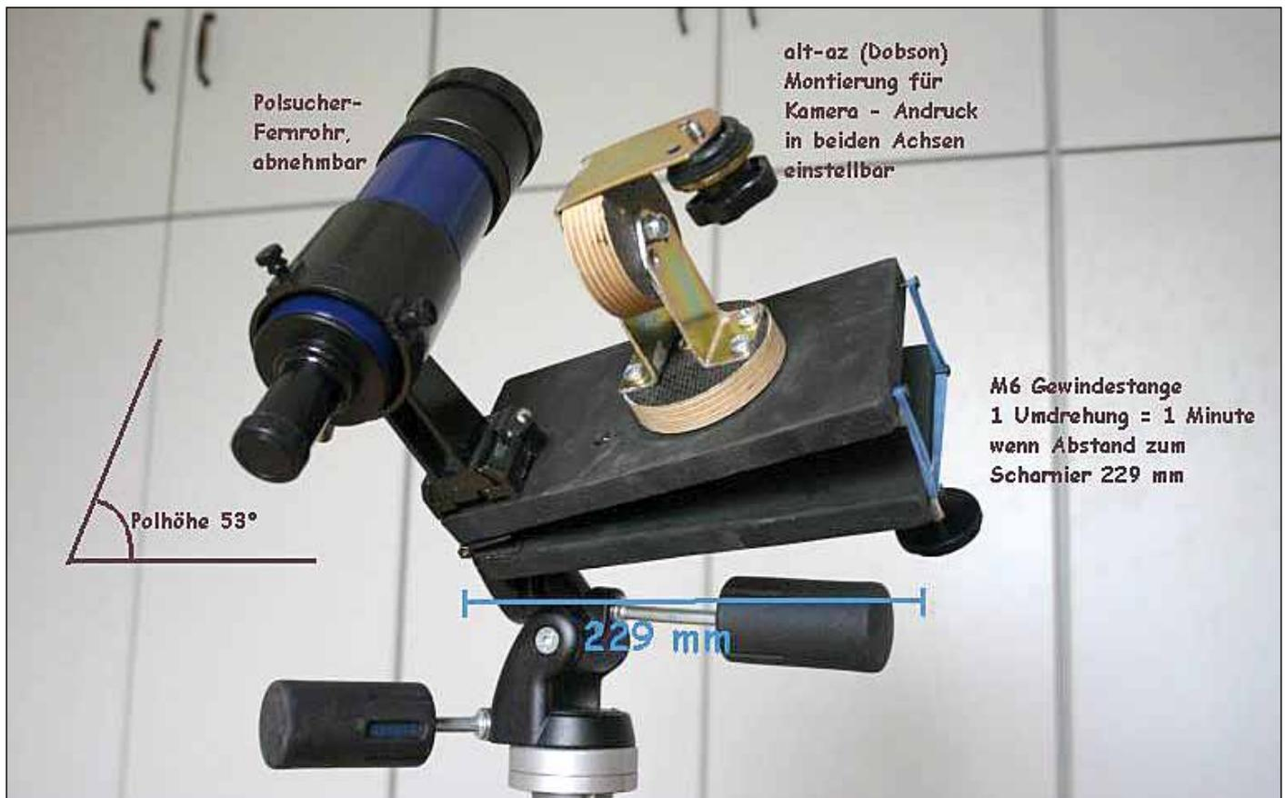
Abb 2: Beispiel einer selbstgebauten Barndoor-Montierung [1]
