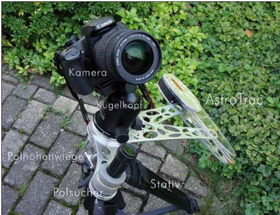
Abb. 3: AstroTrac TT320X-AG mit Polsucher, Polhöhenwaage, Kugelkopf und Kamera
