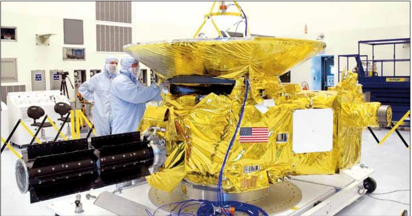
Abb. 7: Raumsonde „New Horizons“ bei der Endmontage [1]
