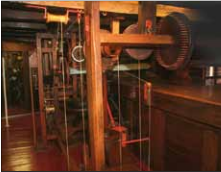
Abb. 5: Ein Teil des Räderwerks, das das Planetarium antreibt. [2]
