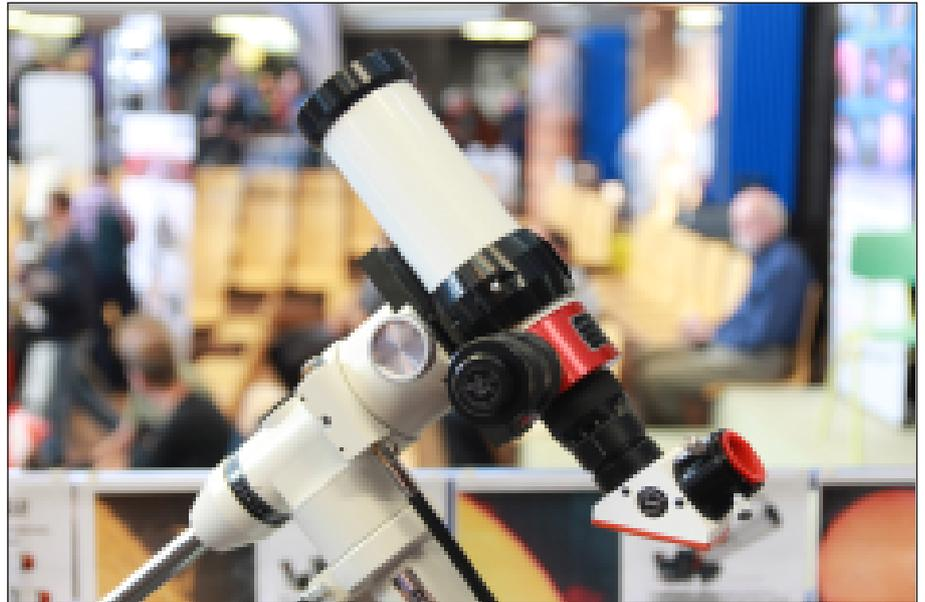
Abb. 9: Lunt 60THa/B1200C - 60-mm-H-alpha-Teleskop, Blockfilter B1200, Crayfordauszug
