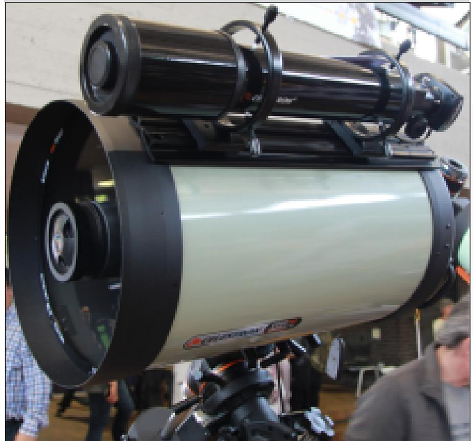
Abb. 6: C14 EDGE-HD Teleskop mit FastStar und automatischer Einnordung mittels CCD-Kamera.
