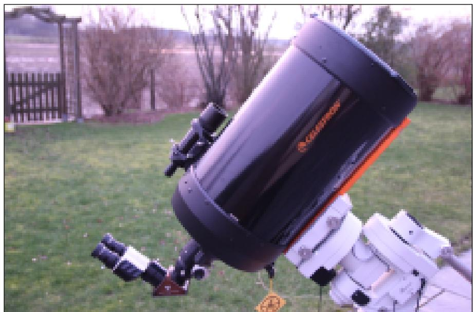
Abb. 2: SC-Teleskop C11 für Planetenaufnahmen.
