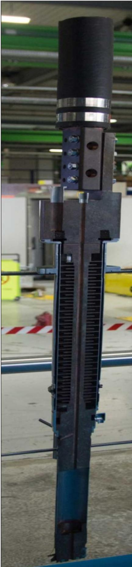
Abb. 7: Umsetzung des Wechselstromanschlusses (oben) auf kleine Supraleitungen (unten).
