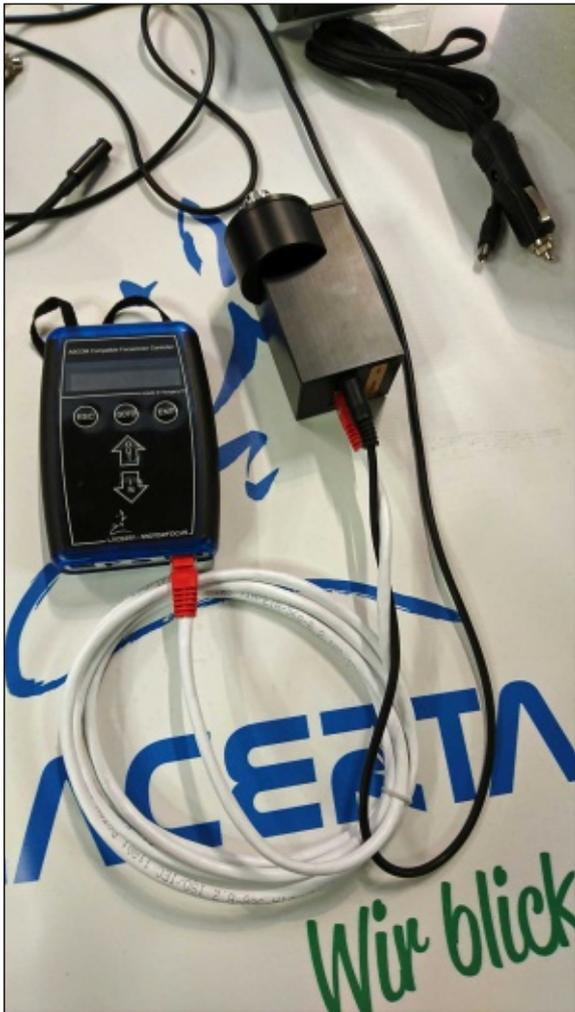
Abb. 7: MotorFocusLA zur automatischen, wärmeabhängigen Fokussierung.
