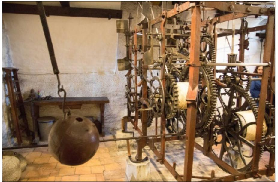
Abb. 12: Zahnradgetriebe der Zytglogge mit Pendelantrieb.
