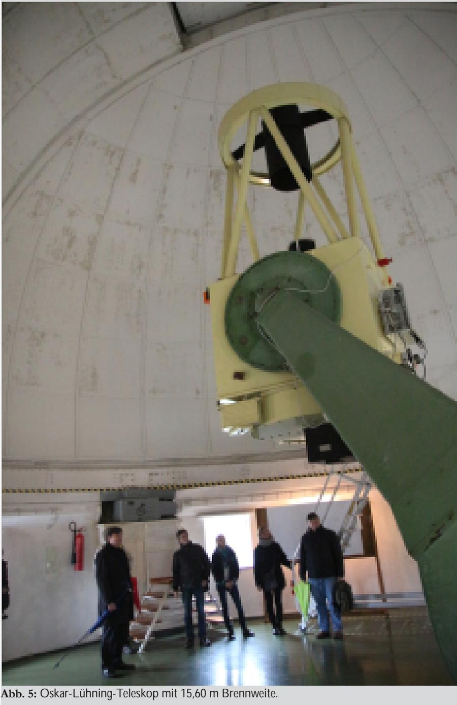
Abb. 5: Oskar-Lühning-Teleskop mit 15,60 m Brennweite.
