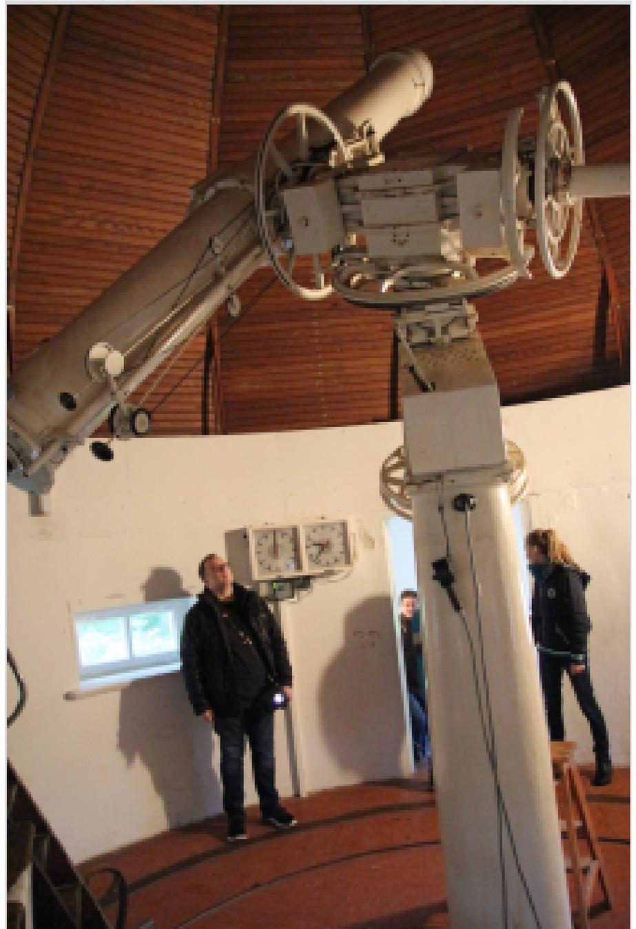
Abb. 6: Das älteste Teleskop der Sternwarte - der Äquatorial-Refraktor.
