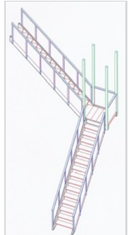
Abb. 3: Außen an den seitlichen Balken aufgehängte, mitdrehende, 90° abgewinkelte Treppe.
