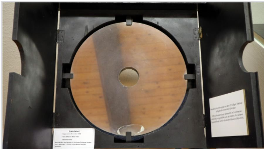
**Abb. 1:** Der „Lochspiegel“ mit einer Brennweite von 3000 mm und einem Durchmesser von 460 mm auf einem Ehrenplatz im Heimatmuseum Lilienthals. Zu beobachten ist in ihm heute nur noch die Deckenverkleidung des Raumes in dem er ausgestellt ist.
