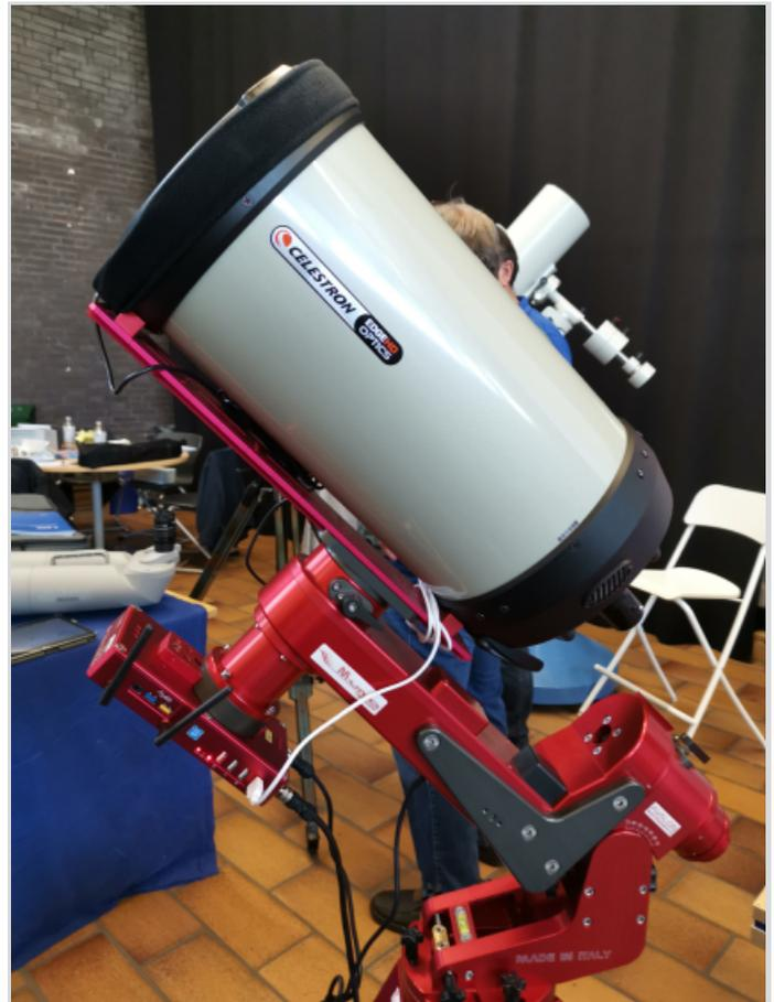
Abb. 5: Computer-Kontrolleinheit EAGLE mit WLAN-Antennen an einem Celestron C11.
