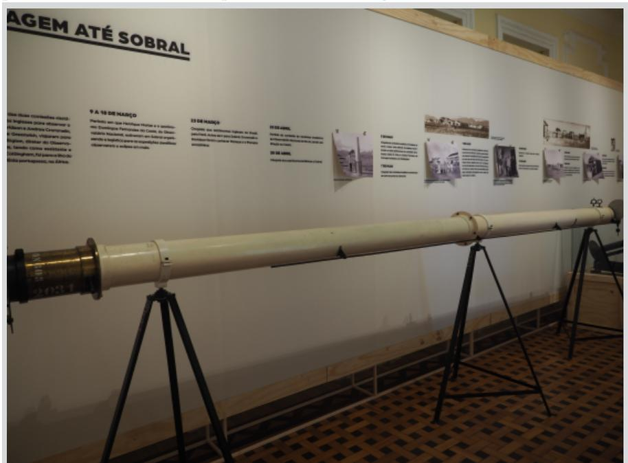
Abb. 3: 80-cm-Spiegelteleskop von Raymond Mailhat, Paris, mit aufgesetzter Kamera wie es in Sobral eingesetzt wurde.
