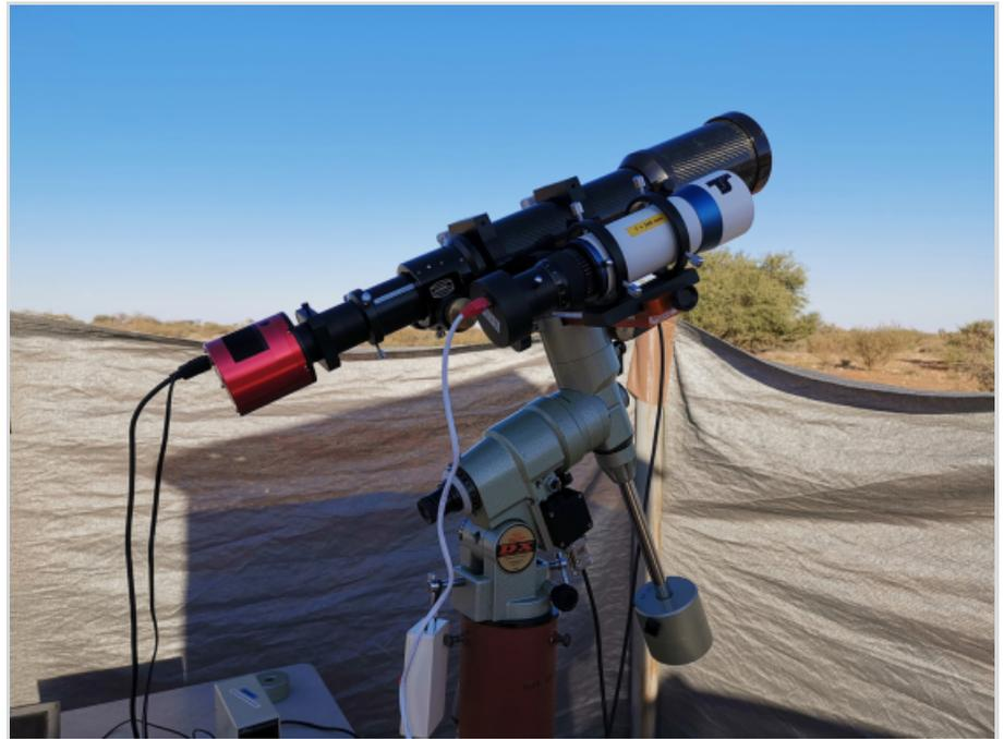
Abb. 6: Eigene Astroplattform mit Säule, eingesüdeter GP-DX-Montierung und TS-Refraktor.
