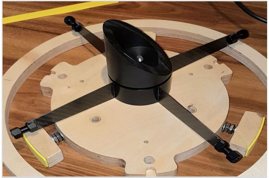
Abb. 7: Die Fangspiegelspinne liegt hier auf Holzwerkzeugen, die für den Einbau der optischen Komponenten in den Tubus angefertigt wurden.
