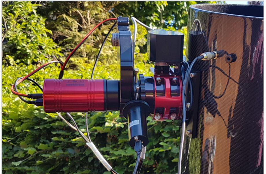
Abb. 13: Imagertrain des Newton Astrographen.
