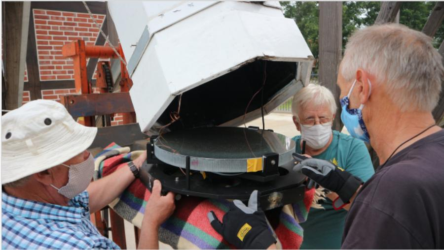
**Abb. 3:** Drei nicht nur in der AVL bekannte „Ärzte“ (F. Knoblauch, H.-J. Leue, G. Willems) beim Ausbau der Spiegelzelle mit Fassung und Hauptspiegel aus dem Fernrohr-Tubus. Die Masken sind bei solch enger Teamarbeit erforderlich seit März des Jahres 2020, dem Jahr „Eins“ des Zeitalters der globalen Verbreitung vom „Covid-19-Virus und der Corona-Pandemie.“ Bild vom Autor.
