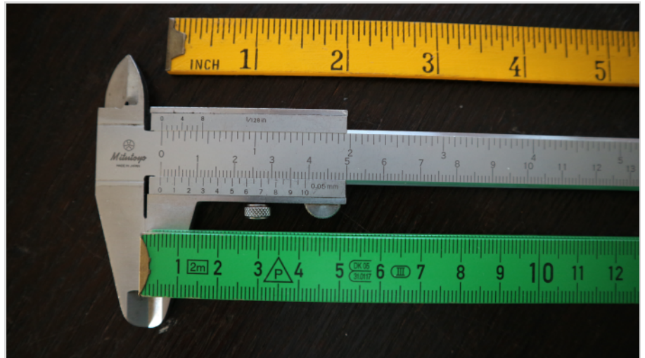
Abb. 4: „Zollstock“, Meterstab und Schieblehre mit den Maßsystemen zöllig und metrisch und ihren Einheiten inch und cm die heute weltweit gültig sind.
