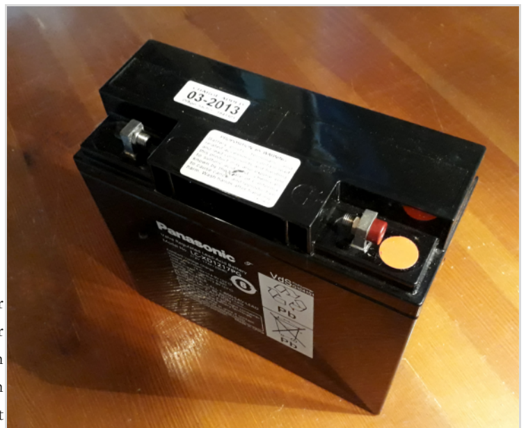
Abb. 3: Buchsen am Gel-Akku für eine sichere Verbindung.
